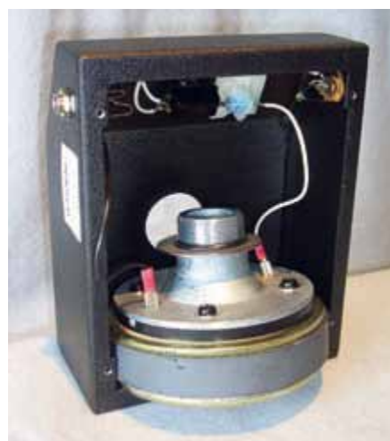
Eine geöffnete Talkbox, der Treiber für den Schlauch ist hier schön zu sehen.
