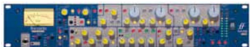
**Der Channelstrip ISA430 MkII von Focusrite beinhaltet einen MicPreamp mit variabler Impedanz auf Basis eines Lundahl-Übertragers. Neben der Verstärkung des Mikrofonsignals ist auch ein Equalizer, ein Kompressor, ein Phasendreher und ein De-esser an Bord.**
