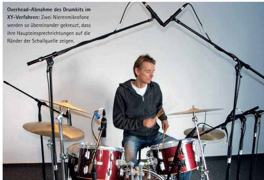
**Overhead-Abnahme des Drumkits im XY-Verfahren:** Zwei Nierenmikrofone werden so übereinander gekreuzt, dass ihre Haupteinsprechrichtungen auf die Ränder der Schallquelle zeigen.
