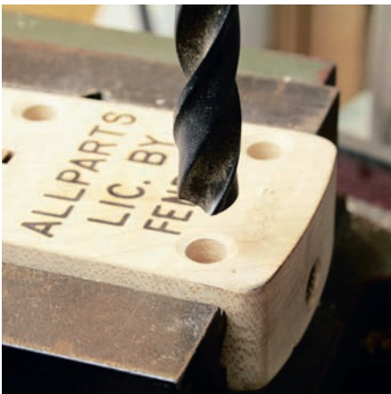
Abb. 8: Bohren und Aufkrausen der Befestigungslöcher
