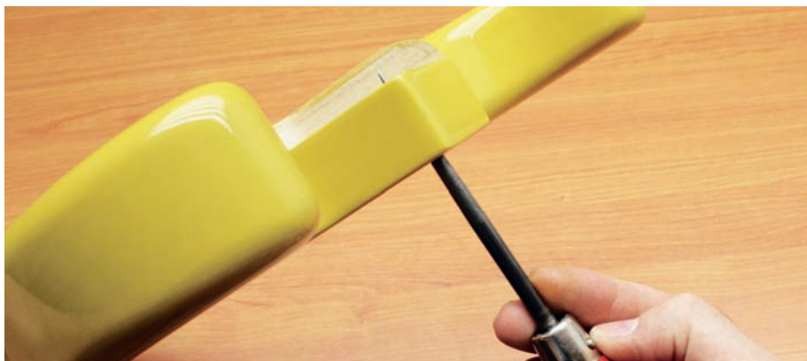
Abb. 1: Ahle zum Markieren der Befestigungslöcher
