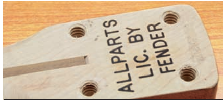
Abb. 9: Vorschneiden und Eindrehen der Muffen
