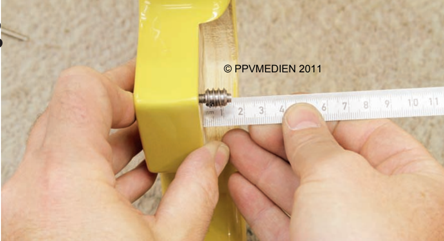
Abb. 7: Ein Anhalten der Schraube zeigt, wie tief die Gewindehülse in den Hals eingesetzt werden muss
