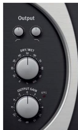
**Mit Hilfe des Wet/Dry-Reglers lässt sich das Originalsignal mit dem Sample nach Bedarf mischen.**
