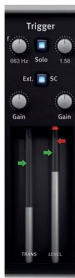
**In der Trigger-Sektion kann man zwei Tresholds einstellen: einen für den Pegel und einen für die Transienten.**
