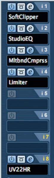
Mastering-Effekte im Insert-Effektweg des Master-Ausgangs.
