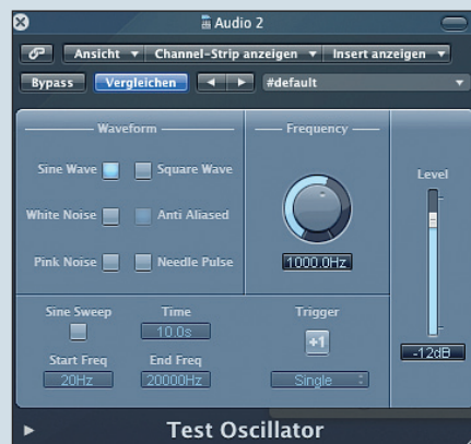
Liefert Testtöne und Sinussweeps: der Test-Oscillator.
