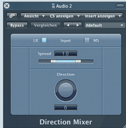
Bietet Zugriff auf die Stereobreite und Mitten- und Seiten-Signal einer Spur: Direction-Mixer.
