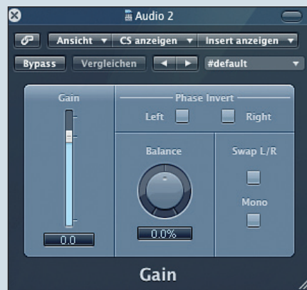
Nützlicher Helfer für Phasendrehungen: das Gain-Plug-in.
