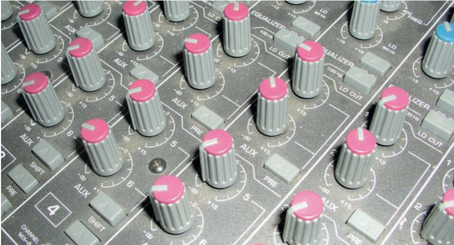
Regler der Aux-Sends: Hier lassen sich die Signale pro Kanalzug auf einen der entsprechenden Sends, also der Ausgänge mischen.
