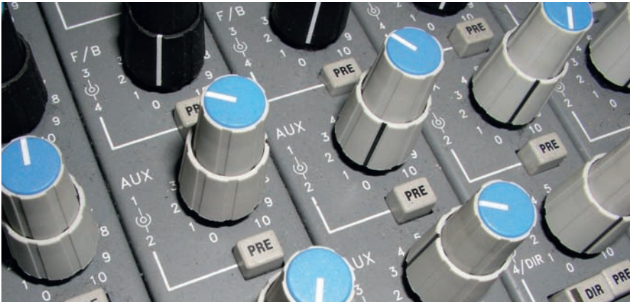
An manchen Konsolen, gerade im Kompaktbereich muss Platz gespart werden. Die Aux-Wege werden dann oft per Doppelregler zusammengefasst.
