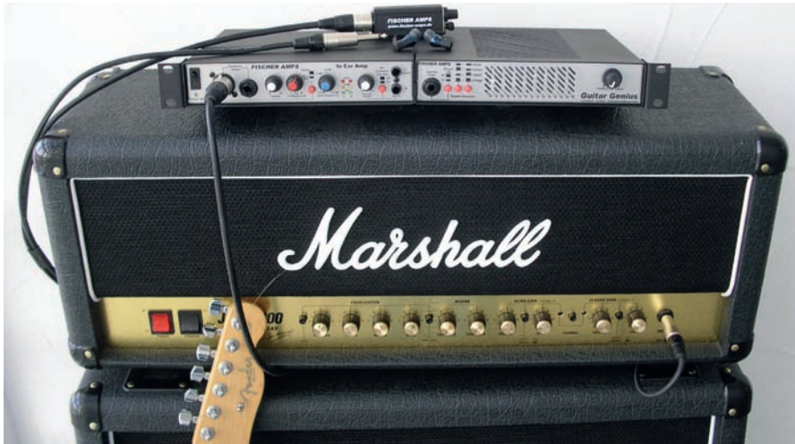
Guitar Genius von Fischer Amps: Neben ihrer Funktion als Lautstärkebremse können so genannte Attenuatoren meist auch als DI-Box mit Speakersimulation eingesetzt werden.
