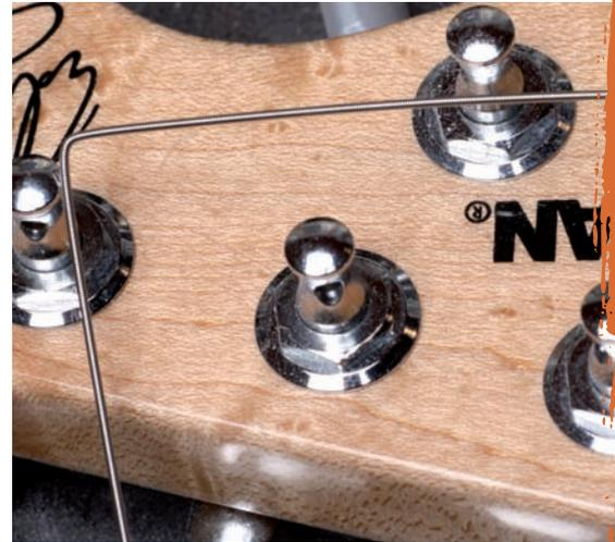
Fünf Zentimeter nach der Achse wird die Saite geknickt
