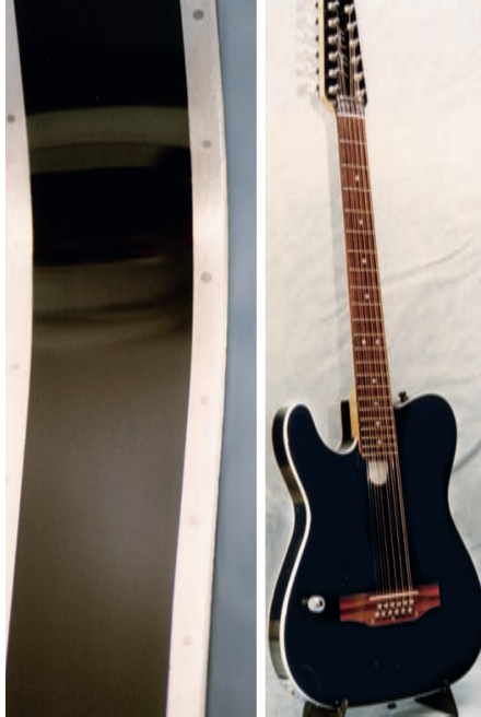
Abb. 3: Das Besondere liegt im Detail: Korpuseinfassung aus Aluminium
