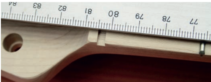
Abb. 12: Das Anlegen eines Lineals, um den Saitenverlauf zu kontrollieren
