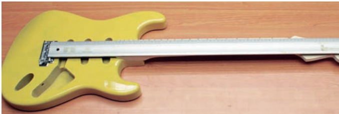
Abb. 11: Gerade erst vereint und schon überprüft: die Flucht von Hals und Korpus
