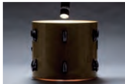
Mittels einer Taschenlampe und einer planen Fläche könnt ihr eure Gratung überprüfen.
