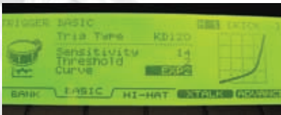
Abb. 5: Laut nur bei sehr harten Schlägen. Auswahl einer flach steigenden Anschlagdynamikkurve.
