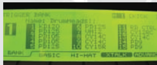
Abb. 1: Die Triggerbank im Display eines E-Drum-Moduls, zeigt, welcher Padtyp am Eingang liegt.
