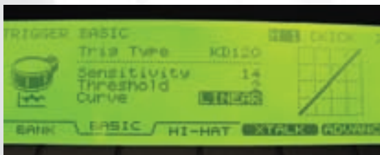
Abb. 6: Laut auch bei sanften Schlägen. Auswahl einer steil steigenden Anschlagdynamikkurve
