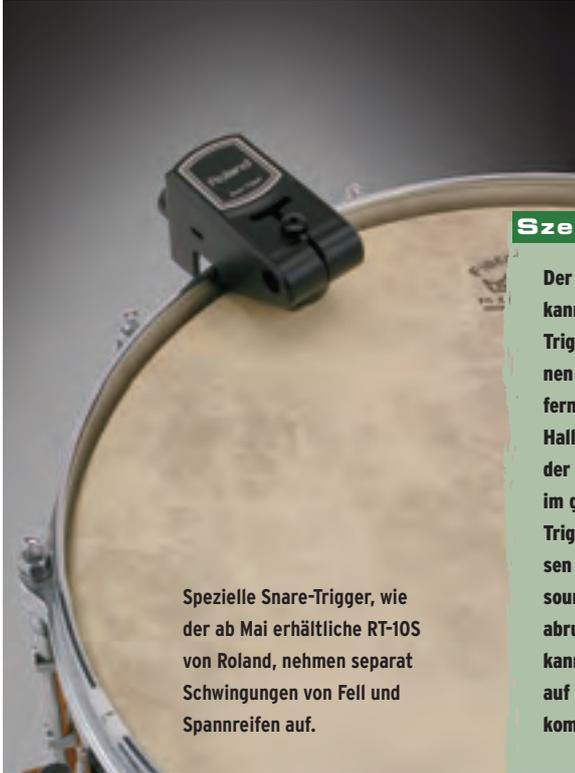
Spezielle Snare-Trigger, wie der ab Mai erhältliche RT-10S von Roland, nehmen separat Schwingungen von Fell und Spannreifen auf.
