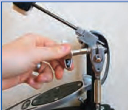
Mit der Einstellschraube oberhalb der Feder ändert ihr Trittplatten- und Schlegelwinkel
