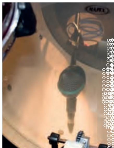
Abb. 3: Die Position des Mikrofons in der Bassdrum bestimmt das Klangergebnis. Bei größerem Abstand zum Schlagfell (links) erhaltet ihr mehr Basston. Knackigen Attack gibts bei Platzierung nah am Fell (rechts).
