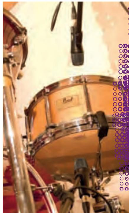
Abb. 2: Schöner Luxus, der mehr Nuancen einfängt: Snareabnahme mit zwei Mikros von oben und unten
