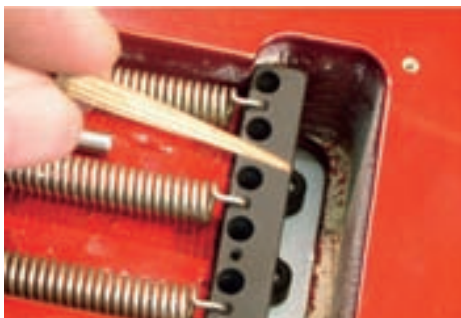
Abb. 11: Fixieren des Vibratoblocks mit einem Keil
