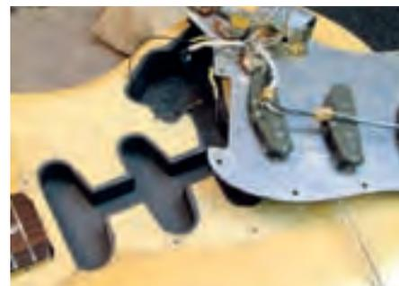
Abb. 3: Die leitende Folie unter dem Schlagbrett muss an Masse gelegt werden – sonst brummt es noch mehr
