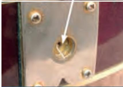
**Abb. 6:** Etwas versteckt: die Masseverbindung bei vielen Jazzgitarrten
