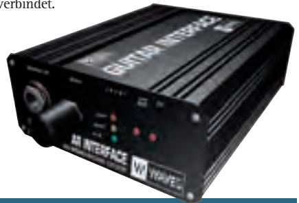
Abb. 6: Eine D.I.-Box dient der optimalen Pegelaufbereitung elektrischer Gitarren und Bässe
