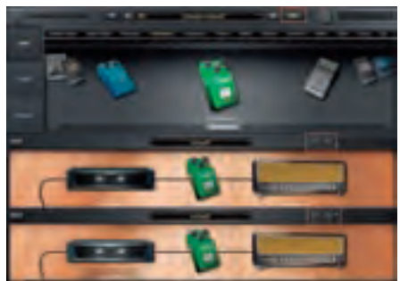
Abb. 14: Im Dual Mode bietet POD Farm gleich zwei Signalwege
