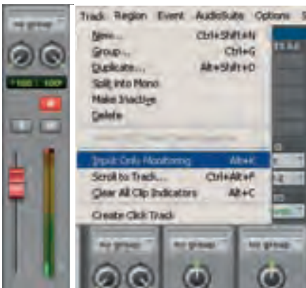
Abb. 5: Für ein Monitoring ist die Aufnahmebereitschaft im Kanal sowie die Option „Input Only Monitoring“ im Track-Menü einzuschalten
