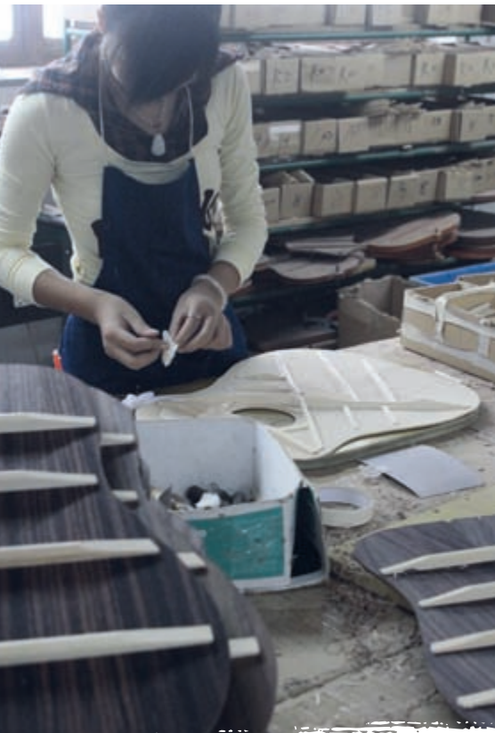
Hier werden die fertig beleisteten Decken nachgearbeitet
