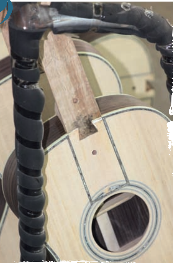
So sieht eine saubere Schwalbenschwanzverbindung aus
