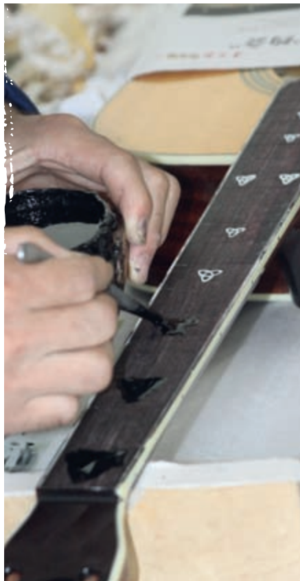
Für die Griffbretteinlagen benutzt man einen speziell gefärbten Leim
