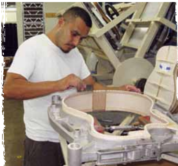
Vor dem Aufleimen von Decke und Boden wird der Zargenkranz mit Leim bestrichen
