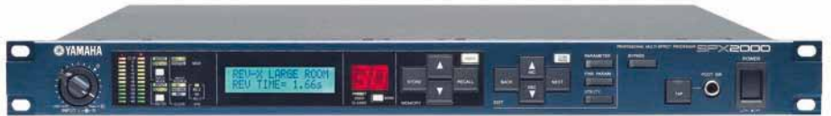
Professionelles Multieffektgerät für Studio und Bühne: Yamaha SPX 2000
