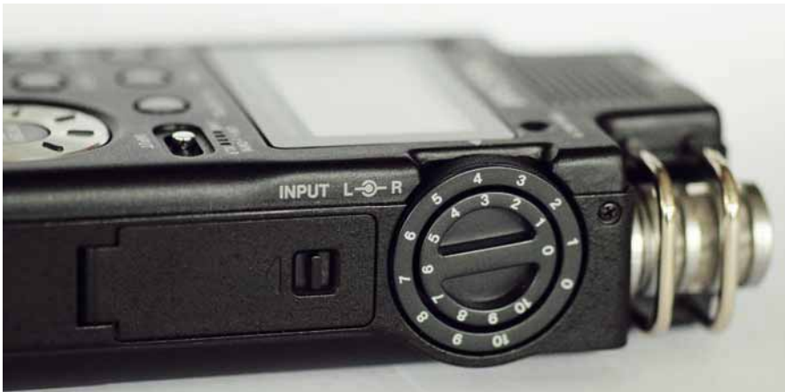
Beim Tascam DR-100 lassen sich die Mikrofone unabhängig voneinander einpegeln.
