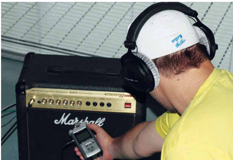
Mit einem Kopfhörer am Pocketrecorder könnt ihr problemlos den Sweetspot am Amp bestimmen.
