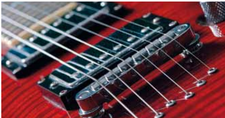
Check your Hardware: Insbesondere wo die Saiten mit Druck aufliegen, dürfen keine scharfkantigen Grate die Saite unnötig belasten.
