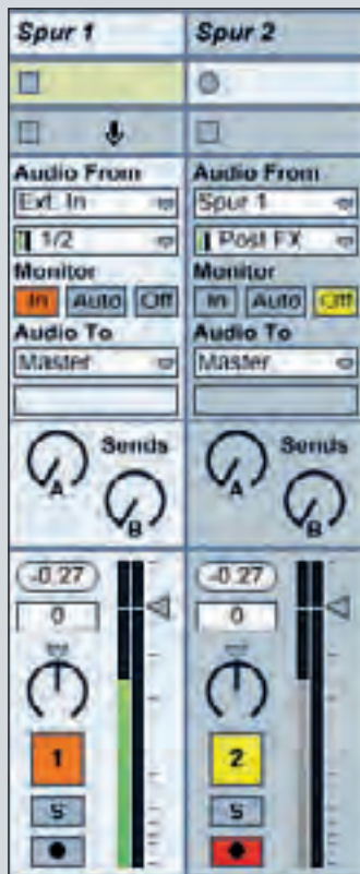
Recording-Channel: Das externe Signal durchläuft die Gerätekette von Spur 1, um anschließend Post FX in Spur 2 aufgenommen zu werden
