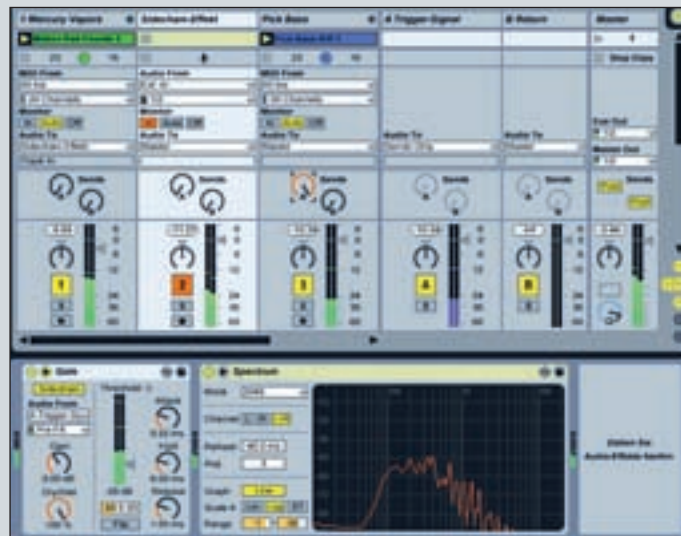
Das Gate wird auf eine Effekt-Spur ausgelagert und das Trigger-Signal über eine Return-Spur zum Sidechain-Eingang geschickt
