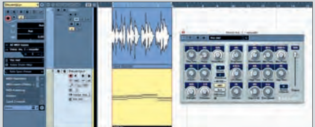
Der Vocoder wird als Insert-Effekt in eine Audiospur geladen und mit einer MIDI-Spur getriggert
