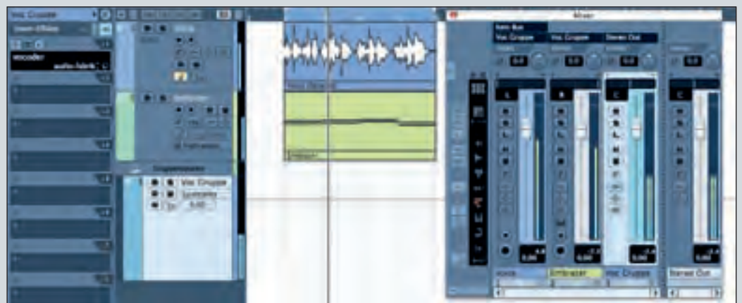
Ein separates Synthesesignal wird mittels eines virtuellen Instruments über eine Gruppenspur mit dem Vocoder „verknüpft“
