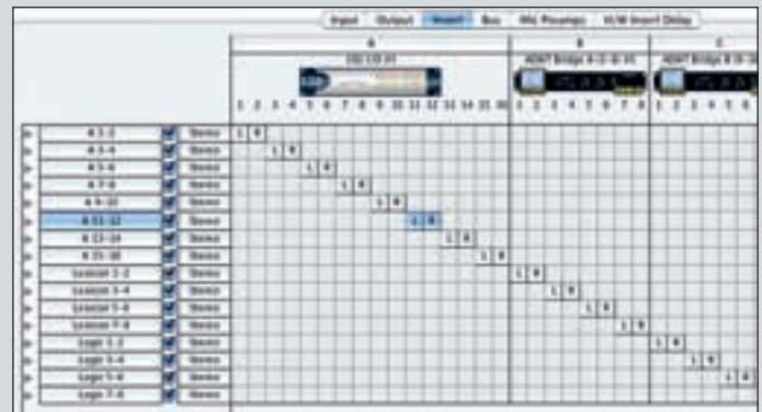
Im I/O-Setup kann man Hardware-Inserts definieren, um beispielsweise externe Effektgeräte ganz einfach in eine Session zu integrieren
