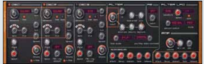
Zwei gegeneinander verstimmte Rechteckoszillatoren, eine leichte Tiefpassfilterung und eine angepasste Lautstärkehüllkurve ergeben eine simple Fläche.
