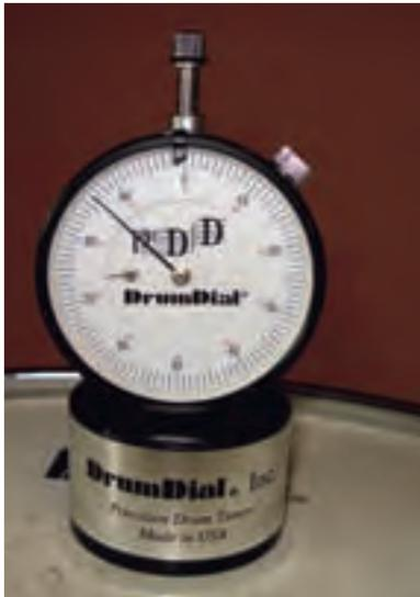
**Das Drumdial ist ein Stimmgerät für Trommeln. Mit einer Feder misst es die Spannung des Fells. Es wird an mehreren Stellen, immer im gleichen Abstand vom Spannrifen, einfach auf das Fell gestellt.**
