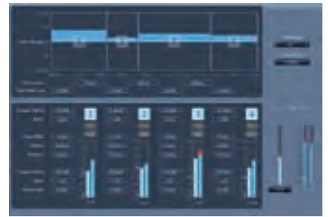
Der Multibandkompressor kann auf bestimmte Instrumente im entsprechenden Frequenzband gezielt eingehen.
