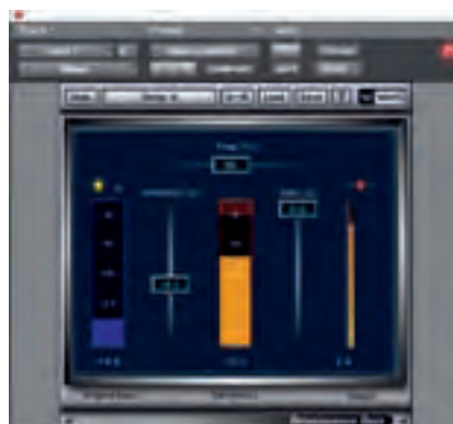
Oben: 120 Hz Sinus im Analyser. Unten: Addition von Harmonischen mit dem PlugIn Renaissance Bass (Settings siehe rechts). Das kann auch einem Bass Durchsetzungsvermögen verleihen.
