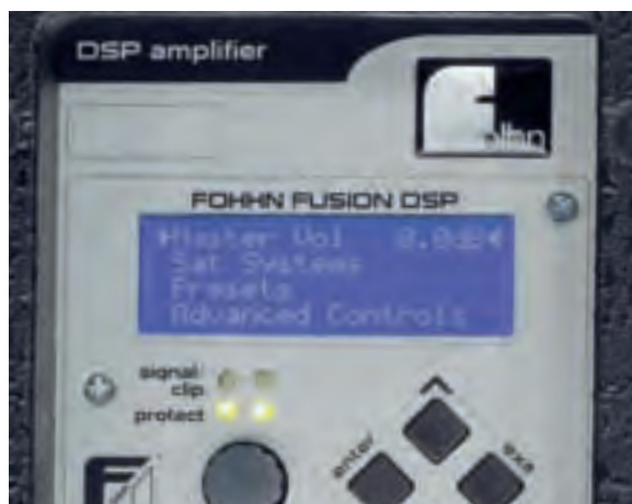
Boxenschutz: In Fohhns Aktivboxen und Amps etwa sind DSPs mit Limitern eingebaut, die den Speaker vor Überlast schützen.
