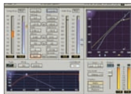
Zwitterwesen: Waves Compander kombiniert einen Kompressor mit einem Expander.
