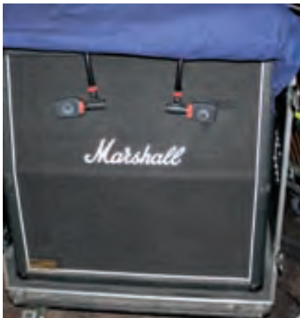
Voller Sound, weniger Lärm: In geschlossenen Boxen abgenommen hat man vollen Röhrensound ohne Krach.
