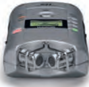
Handlich: Zooms H4 bietet im Handy-Format einen Vier-Spur-Sequencer.
