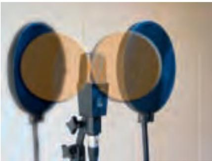
Auch mit einer Achter-Charakteristik kann man mit einem Mikrofon beide Sänger einfangen.
