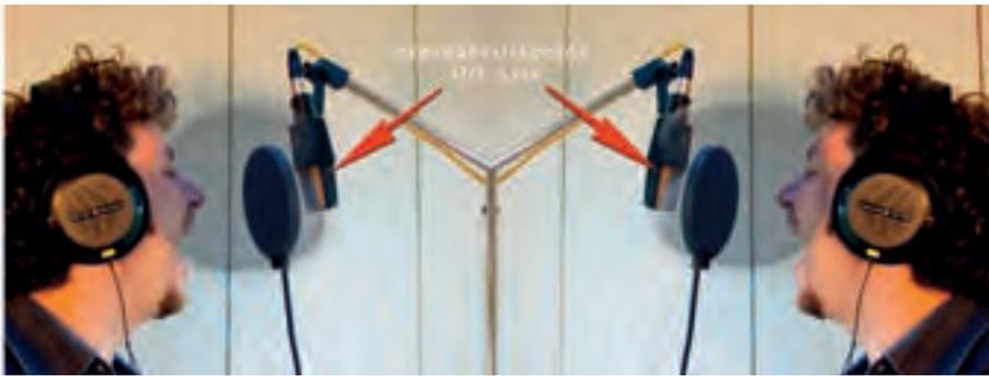
**Zwei gegenüber gestellte Nieren-Mikrofone: Separate Spuren erhalten Bearbeitungsmöglichkeiten.**
