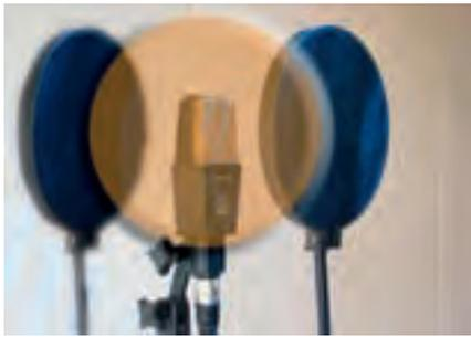
Ein auf Kugel geschaltetes Mikrofon mit Poppschutz um Explosivlaute zu unterdrücken.
