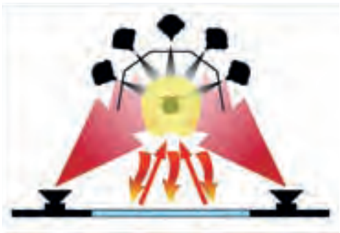
Abb.3: Durch die Verwendung einer Nierencharakteristik kann man rückwertigen Schall bei reflektiven Scheiben besser ausblenden
