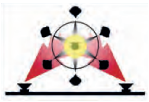
Abb.1: Die einfache Aufstellung im Kreis um ein Kugel-Mikrofon hat die Problematik der Einstrahlung der Boxen, falls man keinen Kopfhörer-Mix bieten kann.
