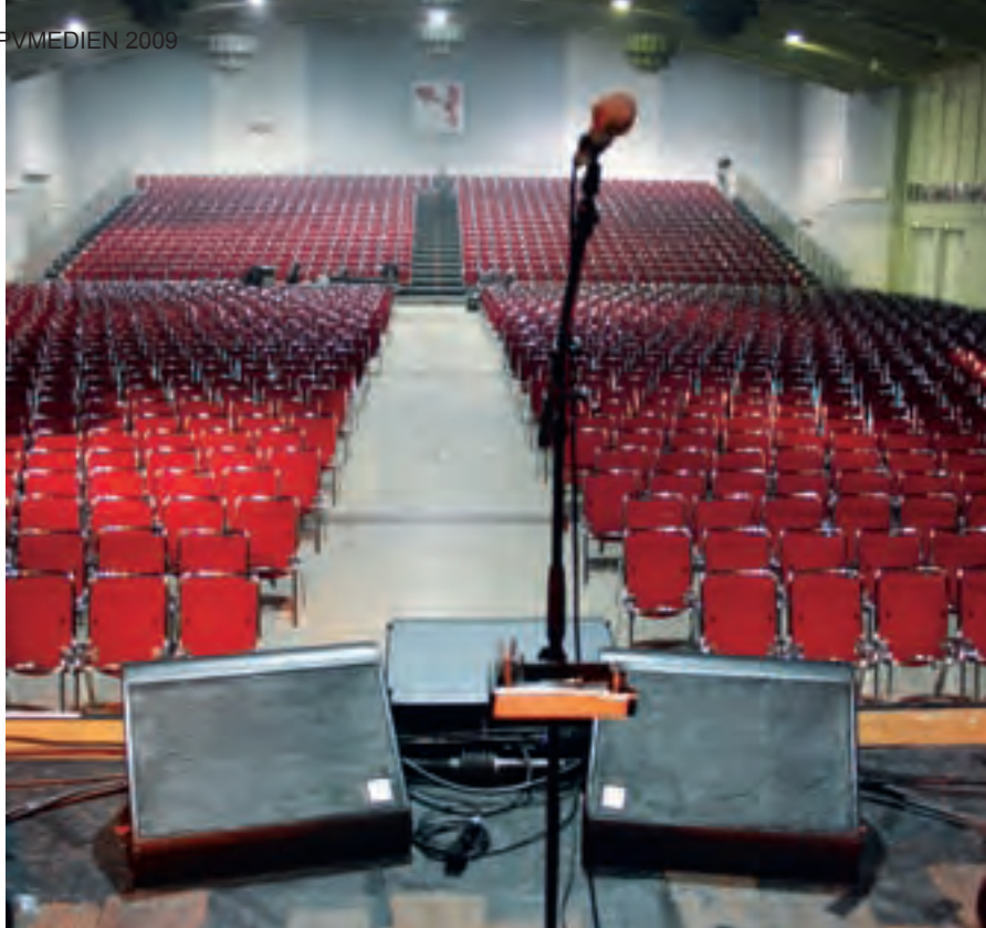
Mikrofon und Monitor: Das perfekte Beispiel für ein Gesangsmikro mit Hyperniere – zwei Monitore schräg davor, dort wo die Hyperniere am unempfindlichsten ist. So ist minimale Feedbackentwicklung garantiert.
