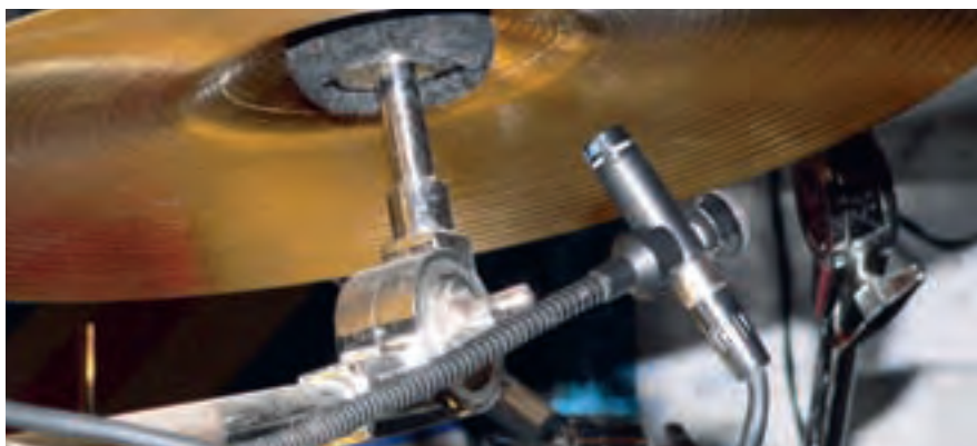
Underhead: Wenn ihr die Becken von unten abnehmt, fangt ihr euch weniger Störschall ein.
