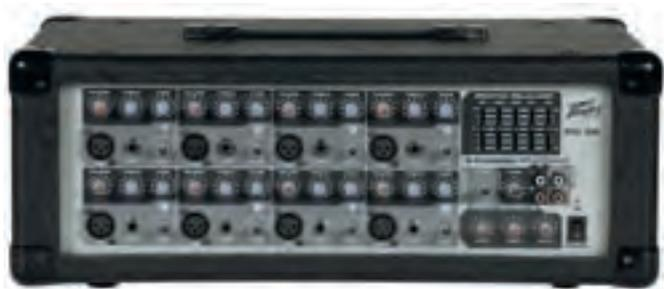
Die kompakten Topteil-Power-Mixer haben bei Peavey eine lange Tradition und sind für ihre Robustheit, soliden Klang und zuverlässige Übertragungswerte sehr geschätzt: Der hier gezeigte PVI 8B besitzt über 150 Watt an 4 Ω.
