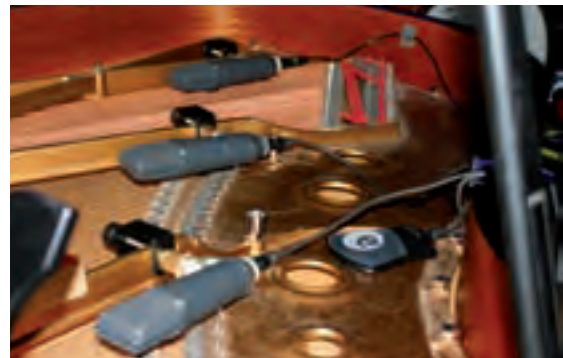
So fangen Profis den Klang eines Flügels ein: Drei Kondensatormikrofone für die Saitenlagen sowie ein Grenzflächenmikro für den Klangkörper:
