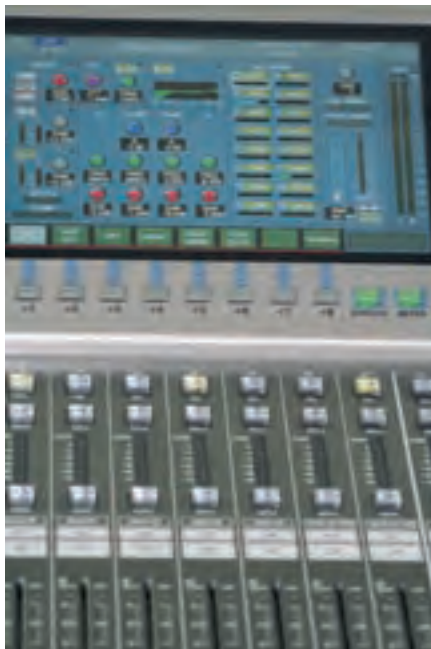
Die 4-Band-Klangregelung mit zwei vollparametrischen Mitten wird bei dem digitalen RSS M-400-Pult im LCD-Display editiert.
