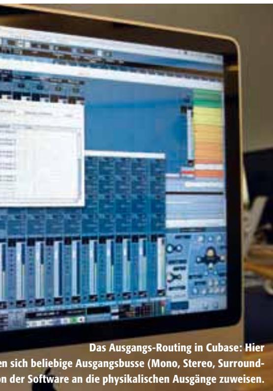
Das Ausgangs-Routing in Cubase: Hier können sich beliebige Ausgangsbusse (Mono, Stereo, Surround) an die physikalischen Ausgänge zuweisen.
