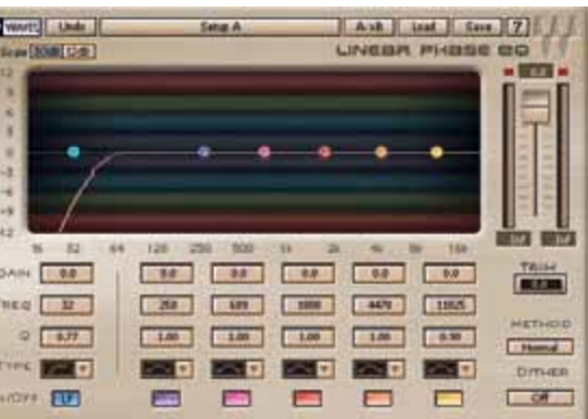
Durch die LinearPhase-Technologie kommt es zu keinen Pegelunterschieden zwischen rechtem und linkem Kanal.
