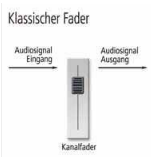
Hier sieht man den Signalfluss eines Audiosignals bei einem klassischen Fader ...
